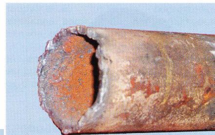
Так выглядит сечение трубы через несколько месяцев работы приборов
