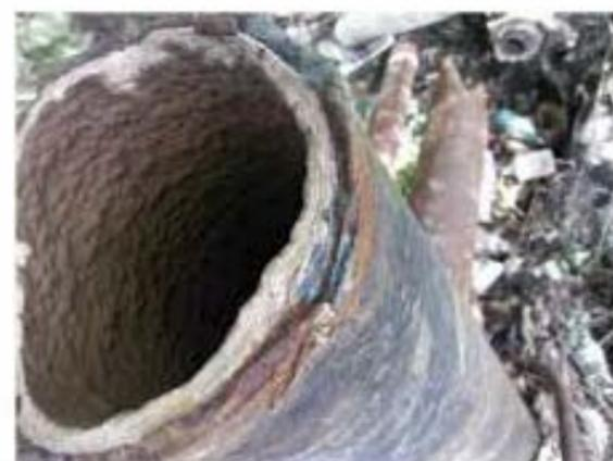
Загрязнение теплообменных поверхностей нагревателя накипными отложениями не только снижает эффективность его работы и требует периодической остановки для проведения очистки, но и, что самое важное, вызывает цепочку экономических потерь при производстве, транспортировке и потреблении тепла.
